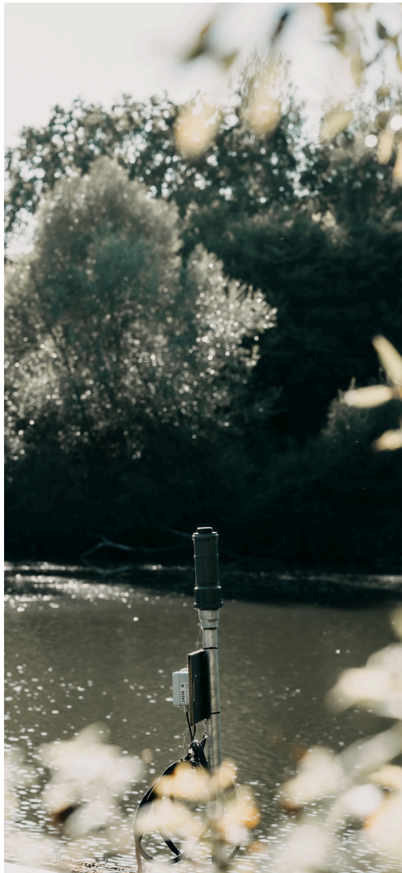
An dieser Drucksonde wurden zur Kontrolle der Wasserqualität vorübergehend mobile Sensoren installiert.
